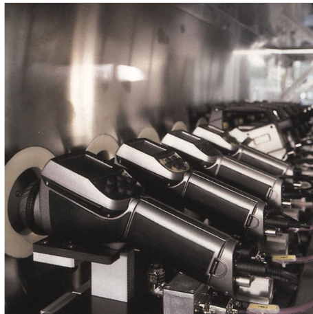
그림 11.5 왼쪽: 기후 조건실에서 적외선 카메라 시험; 오른쪽: 카메라 검사 및 보정 로봇
