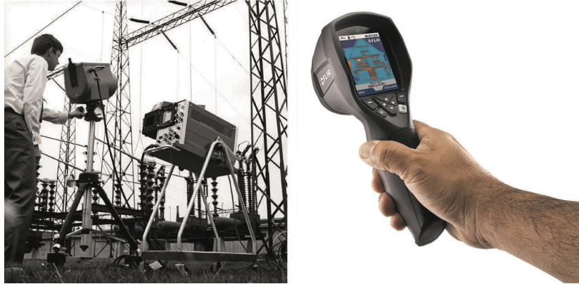
그림 11.2 왼쪽: 1969년 출시된 Thermovision 모델 661. 카메라 무게는 약 25kg, 오실로스코프는 20kg, 삼각대는 15kg입니다. 220VAC 발전기 세트와 액체 질소가 들어있는 10L 용기도 필요합니다. 오실로스코프 왼쪽에 폴라로이드 부착물(6kg)을 볼 수 있습니다. 오른쪽: 2012년 출시된 Flir i7. 무게: 배터리 포함 0.34kg.
